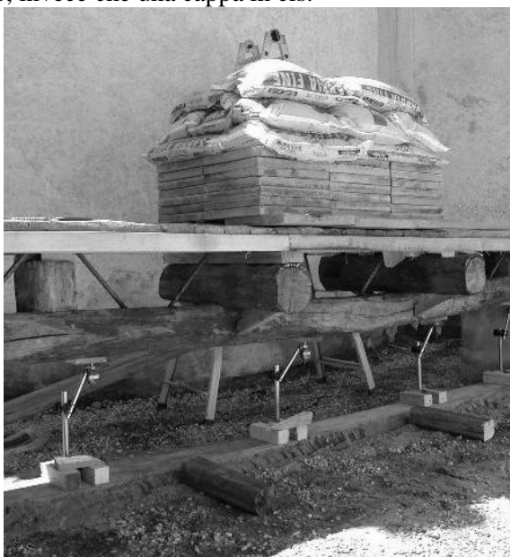
figg. 7a; 7b; 7c - Villa della Porta Bozzolo a Casalzuigno a) e b) consolidamento delle travi di copertura c) prova di carico su un elemento ricostruito a piè d'opera
